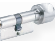
Profil-Knaufzylinder Nr. 815 RHM Messing matt vernickelt eine Seite Schließfunktion, andere Seite Alu-Knauf, F1 diverse Knaufformen erhältlich (abgebildet Form H)
